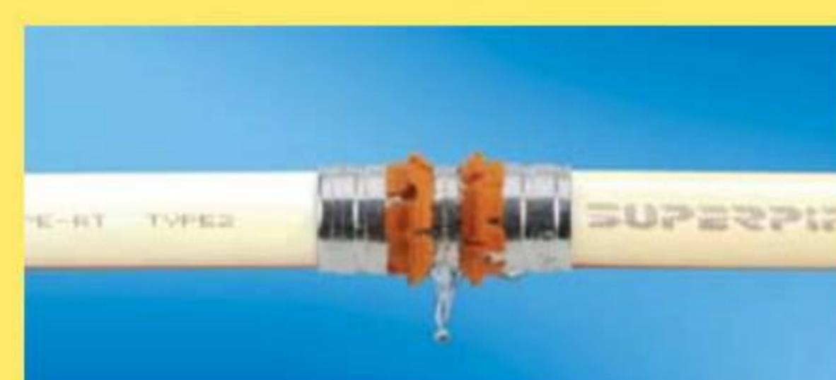
گاهی ممکن است یک اتصال در مسیر اجرابه دلیل خطای انسانی پرس نشود. در سیستم لوله کشی سوپرپایپ<sup>۲+</sup>، هنگام تست فشار، آب از محل این اتصال چکه می‌کند، و مجری فرست دارد تا اتصال پرس نشده را پرس کرده، از بروز نقص احتمالی در عملکرد آتی سیستم جلوگیری نماید.
