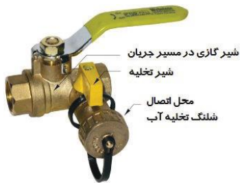
شیر پرچ: ترکیب شیرگازی و شیر تخلیه برای پر کردن مدار
